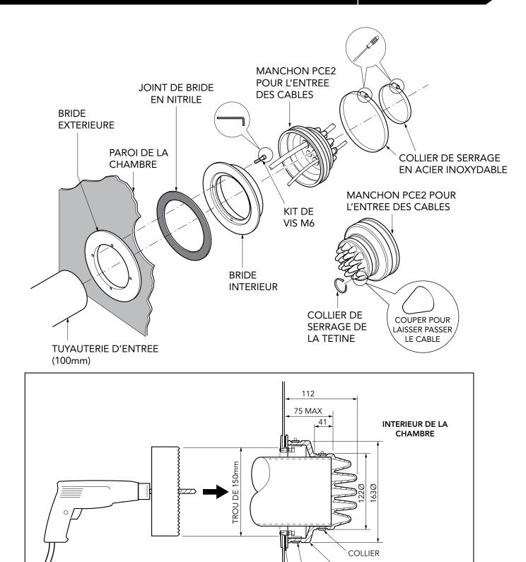
NB: Utiliser la taille correcte de scie cloche en fonction du presse étoupe. L'angle de sortie de la tuyauterie doit être le proche possible de 90°. La gaine doit être parfaitement alignée par rapport au presse étoupe. Lors du remblayage, s'assurer que les gaines ne soient pas dérangées.
