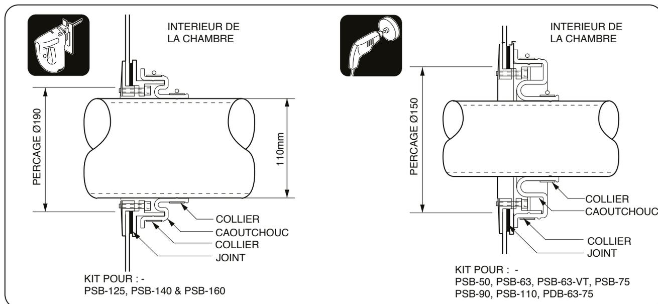
Le tuyau doit traverser la chambre avec un angle au plus près de 90°. Le tuyau doit être centré dans le presse étoupe. Lors du remblaiement, s'assurer que le tuyau garde sa place au centre du Presse étoupe.
