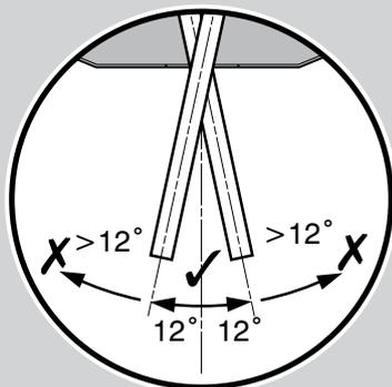
Marquer la position verticale et horizontale de l'entrée de la tuyauterie dans la chambre. La tuyauterie doit pénétrer à travers la chambre avec un angle au plus proche de 90° par rapport à la surface de la chambre. Cet angle ne doit pas dépasser 12° par rapport à l'axe.
