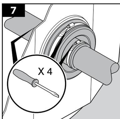
Mettre en place et serrer les colliers. Le couple de serrage doit respecter les recommandations du fabricant de tuyau.
